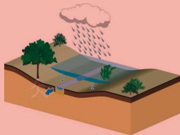
FIGUUR 1 Infiltratietechnieken, zoals een wadi, zorgen voor een duurzaam waterbeheer waarbij hemelwater in de grond infiltreert. (bron : Architecture & Climat)
